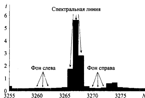
Рис. 1. Пример выбора диодов для вычисления интенсивности спектральной линии ( N — номер фотодиода)
