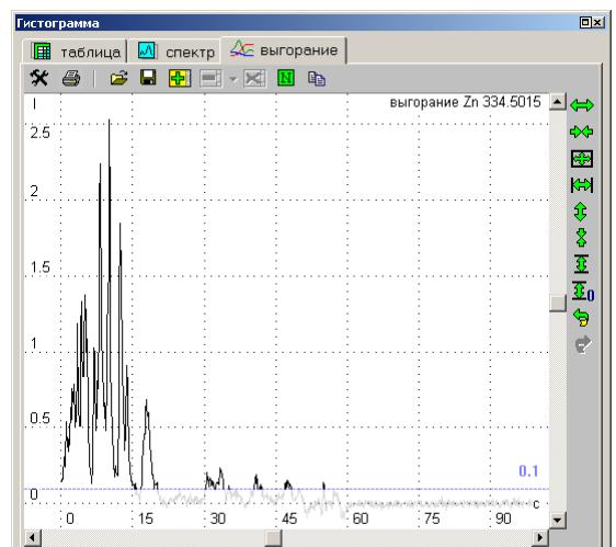
**"Порог интенсивности"** – способ вычисления интенсивности спектральной линии основан на анализе «записи выгорания», в каждом из записанных участков вычисляется интенсивность, сравнивается с порогом, все большие значения интегрируются или усредняются. Результат выводится как значение интенсивности спектральной линии в таблице анализа и используется для дальнейших расчетов.
