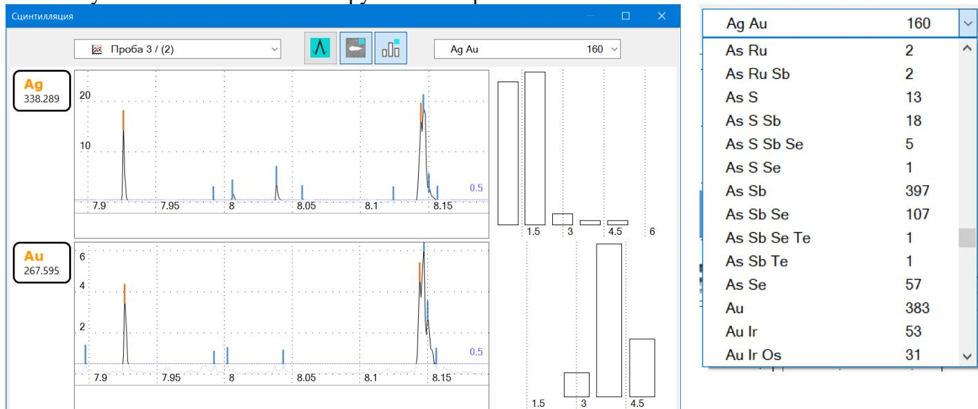
Выбирая в выпадающем списке строку, например «Ag Au 160», мы получим в окне «Сцинтилляция» две гистограммы – записи выгорания для соответствующих линий Ag и Au, по которым программа проводила расчет. Навигация с помощью курсора выполняется согласовано и упрощает визуальный анализ полученных данных. При правильном выборе групп записываемых выгораний возможен надежный качественный анализ дисперсных минеральных форм, которые могут содержаться в исследуемом образце порошковой пробы.
