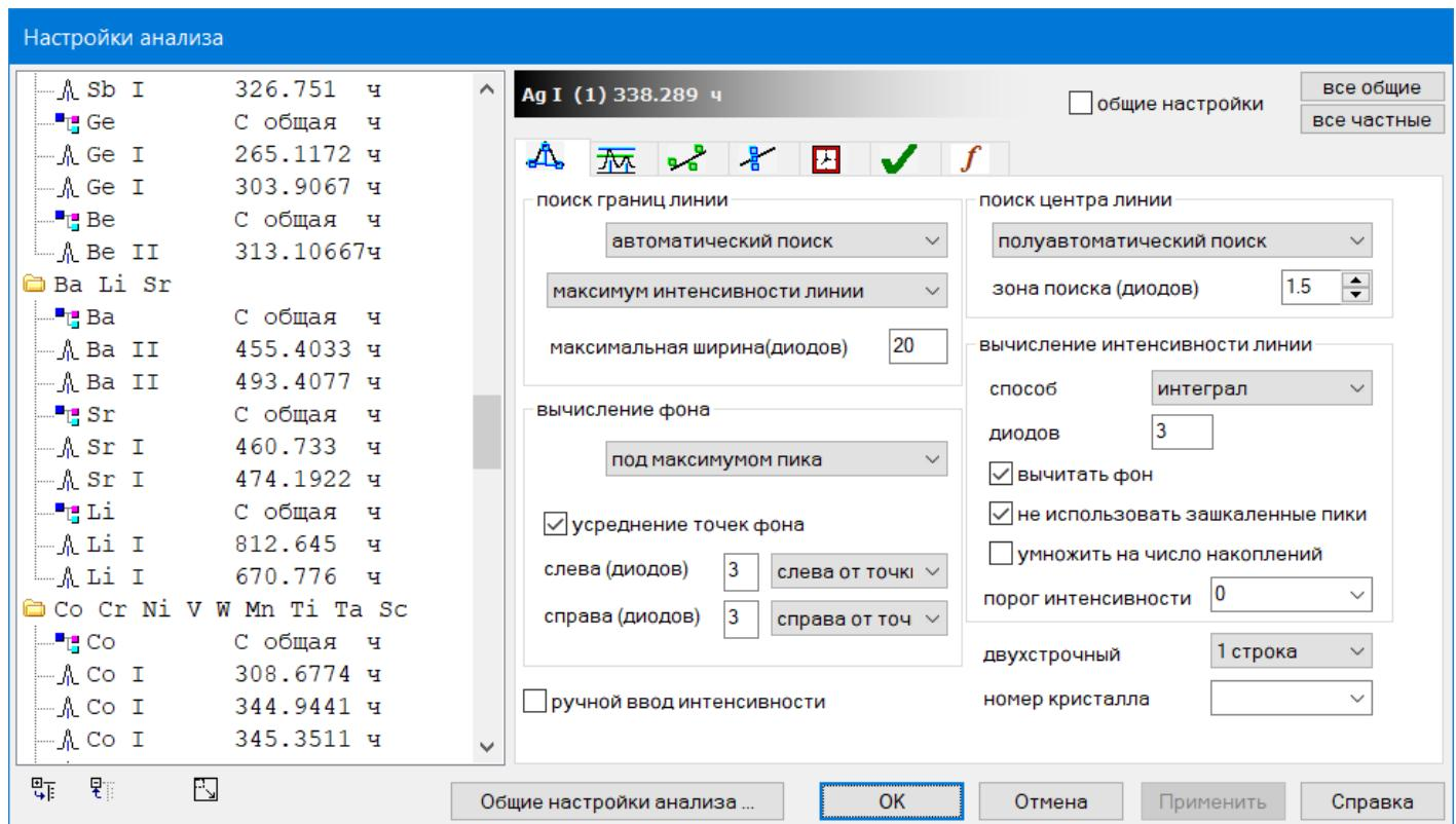
Диалог вызывается кнопкой
