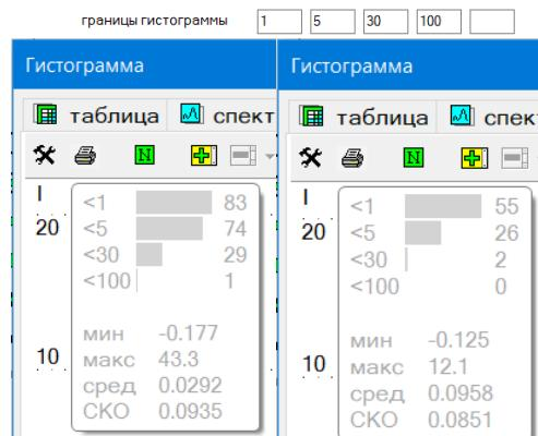
**Базовый:** в каждом записанном участке спектра вычисляется интенсивность спектральной линии, как если бы это был обычный интегральный спектр. В итоге получается набор/массив интенсивностей длиной в число накоплений – обычно от 2000 до 4000. При навигации в окне «Гистограмма» установленный на любой участок гистограммы курсор приведет к показу в окне интегрального спектра соответствующего временного участка спектра с отображением зоны интегрирования и точек фона.
