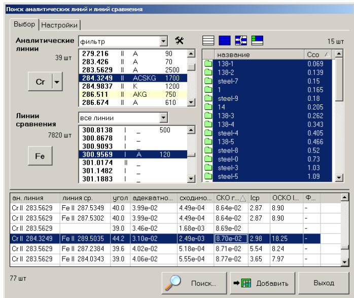
Инструмент для автоматического поиска аналитических пар линий вызывается из меню «Инструмент». Позволяет выбрать разные варианты подбора комбинаций аналитических пар и указать индивидуальные настройки вычисления интенсивностей спектральных линий
