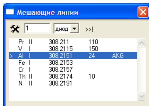
Предназначен для определения возможных наложений спектральных линий, а также для поиска линий, попадающих под указанный участок спектра. В окне выводятся линии, отстоящие от текущей линии не дальше, чем на величину, заданную в поле для ввода над списком. Выводится название элемента, степень ионизации, длина волны, интенсивность и тип линии. Окно мешающих линий можно перемещать и менять его размеры.
