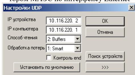
В случае работы МАЭС с интерфейсом Ethernet, когда в системе установлена программа контроля типа «Брандмауэр» или аналогичная, обязательно следует разрешить обращение к локальной сети случае компьютер может заблокировать работу с МАЭС из соображений безопасности. Также работе может помешать антивирусная программа
