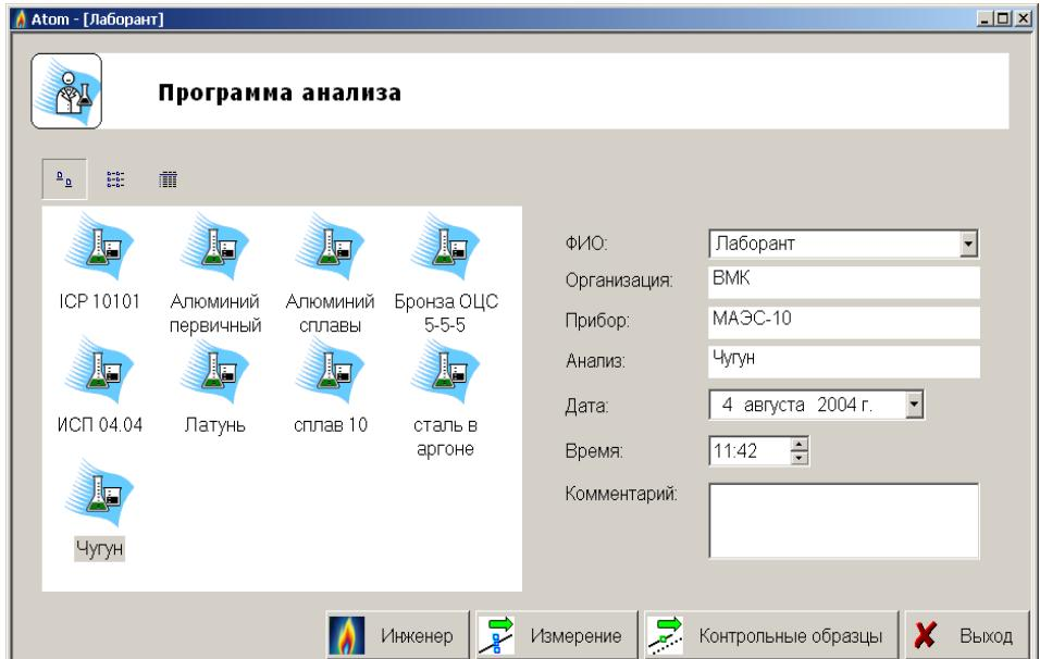
Режим состоит из серии окон, каждое из которых предназначено для выполнения отдельной операции – «Выбор программы анализа», «Измерение», «Переградуировка», «Титул», «Отчет». Для перехода к нужному режиму нажмайте соответствующую кнопку. Для выхода из режима "Лаборант" нажмите "Выход".
