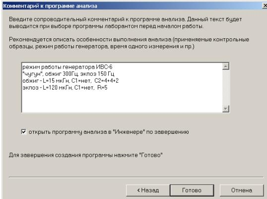
Последний этап в создании – описать в комментарии особенности выполнения программы — применяемые контрольные образцы, режим работы генератора, время одного измерения и пр.
