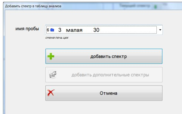
Окно ввода имени составного имени пробы в виде одного поля с разделителем (символ «пробел»). В качестве разделителя можно указать любой символ, тире, запятую и т.д.
