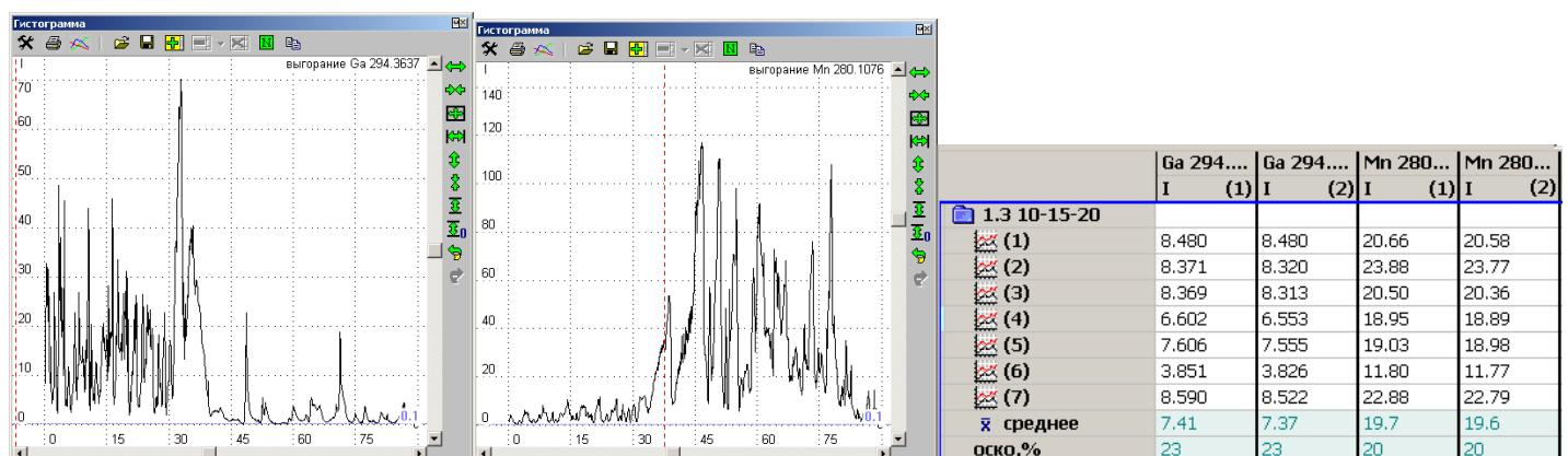
Для ярких линий постоянно присущих в плазме элементов наблюдается практически полное соответствие расчета по среднему спектру за всю экспозицию. В таблице интенсивности линий Ga 294.3637 и Mn
