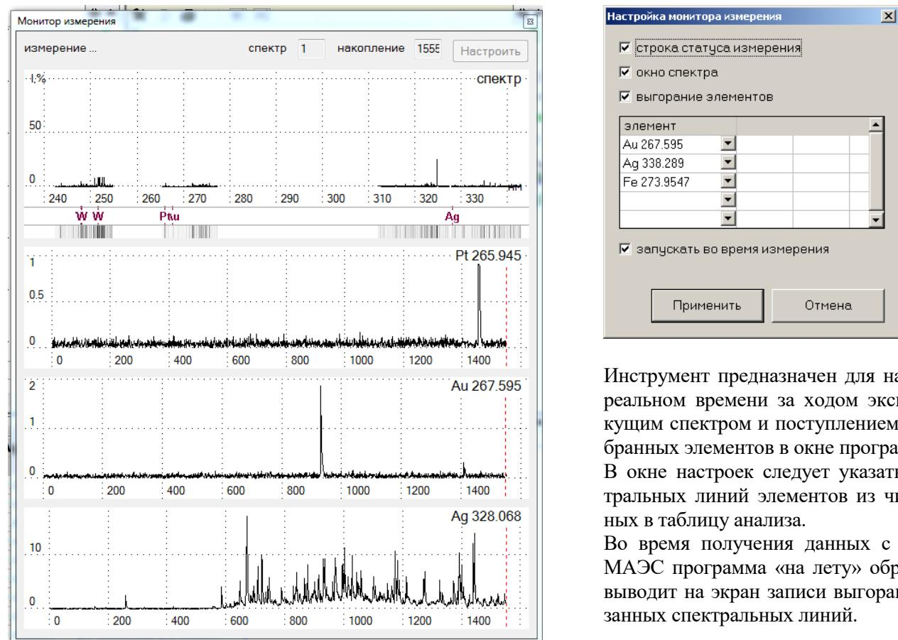
Инструмент предназначен для наблюдения в реальном времени за ходом экспозиции, текущим спектром и поступлением заранее выбранных элементов в окне программы.
