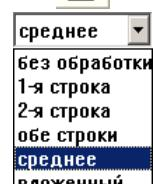
При работе со спектрами, зарегистрированными на «двустороннем» МАЭС можно указать предпочтительный вид: «без обработки» - вся информация выводится подряд; «1(2)-я строка» - только соответствующая строка; «обе строки» - одновременно выводятся обе строки в соответствии с взаимным расположением; «среднее» - спектры отдельных строк «соединяются» в один средний спектр без разрывов и наложений.
