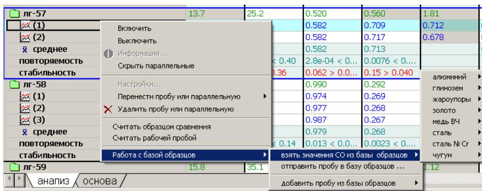
Режим удобно использовать при методической работе, подборе режимов и параметров вычисления градиуровочных зависимостей. Пункт меню «Считать образцом сравнения» «включает» отключенную ранее СОС.
