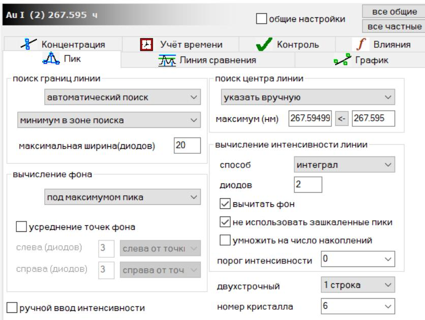
Диалог вызывается по кнопке , закладка "Пик" и предназначен для настройки параметров поиска и вычисления интенсивности линий в спектрах.
