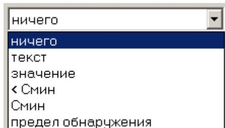
**"если не удалось вычислить С, то выводить ..."** – в случае, когда невозможно вычислить концентрацию, например, из-за отсутствия аналитической линии, отрицательного значения в линейных координатах и т.п. можно выбрать подходящий вариант: пустая ячейка, текстовая строка, числовое значение, значение Смин или предела обнаружения, рассчитанных из градуировочного графика.
