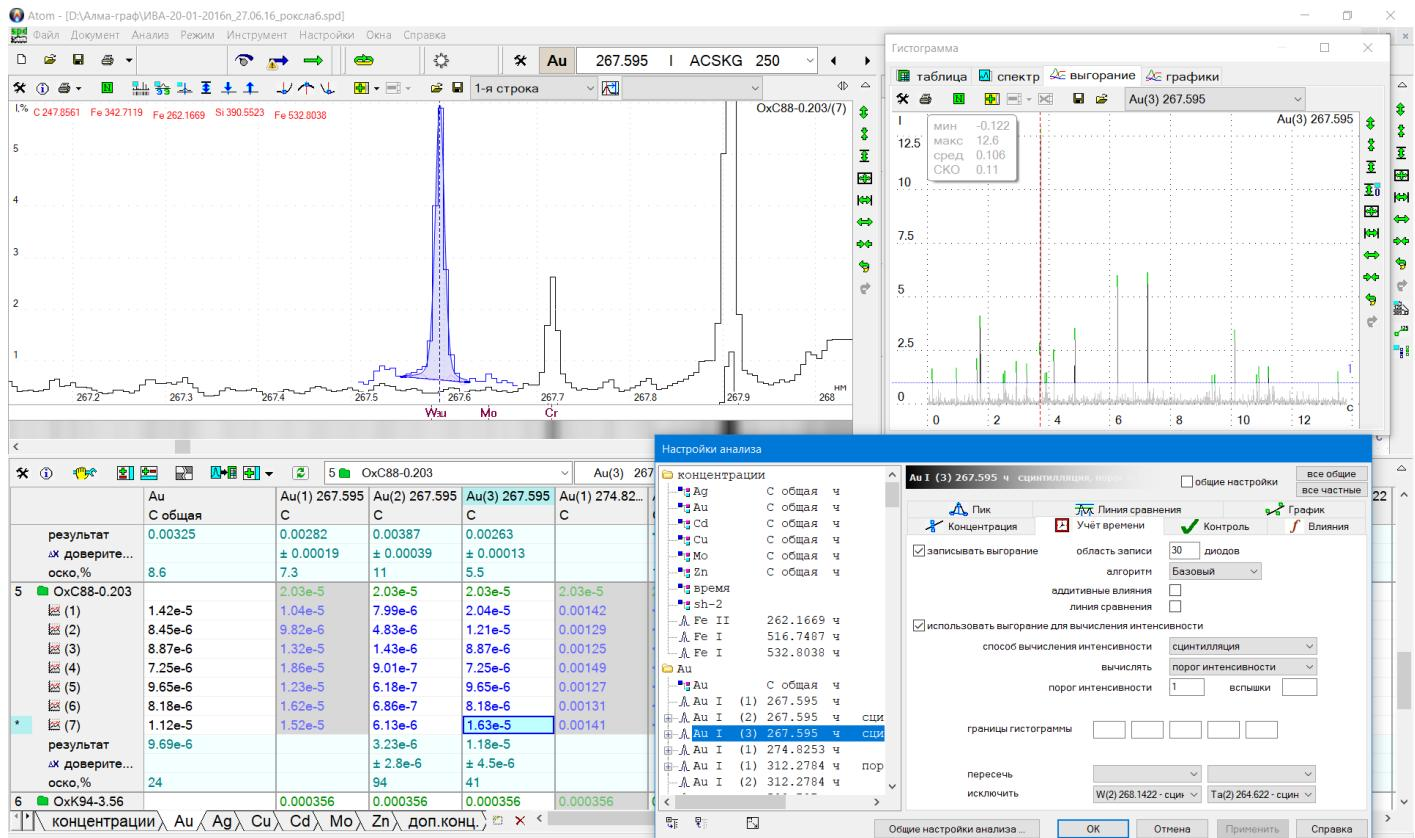
Параметры настройки вычисления аналитического сигнала, который выводится в колонке Интенсивность Таблицы анализа. Программа предлагает следующие варианты/алгоритмы вычисления:
