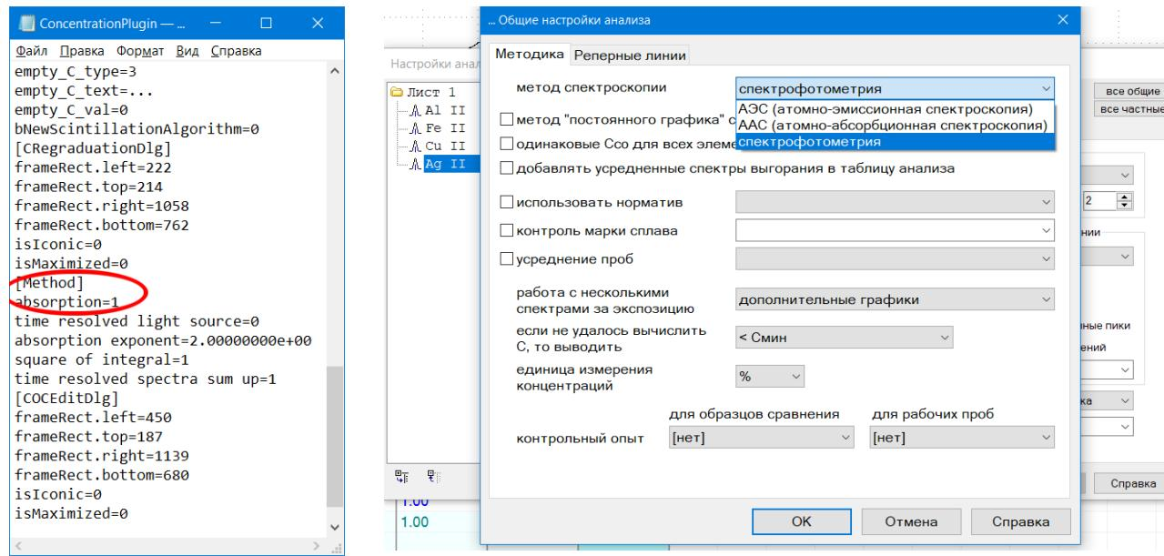
При выборе AAC и спектрофотометрии в панели управлением съемкой спектров появится дополнительная кнопка «желтая стрелка» , которая обеспечивает регистрацию чистого непрерывного спектра основного источника света – дейтериевой, галогеновой или дуговой лампы. Измеренный спектр выводится в окне спектра в единицах оптических плотностей (D).
