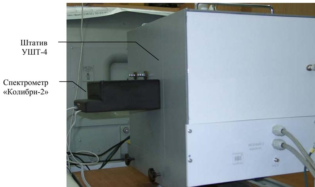
Рис.4 Внешний вид спектрометра «Колибри-2», установленного на штатив УШТ-4
