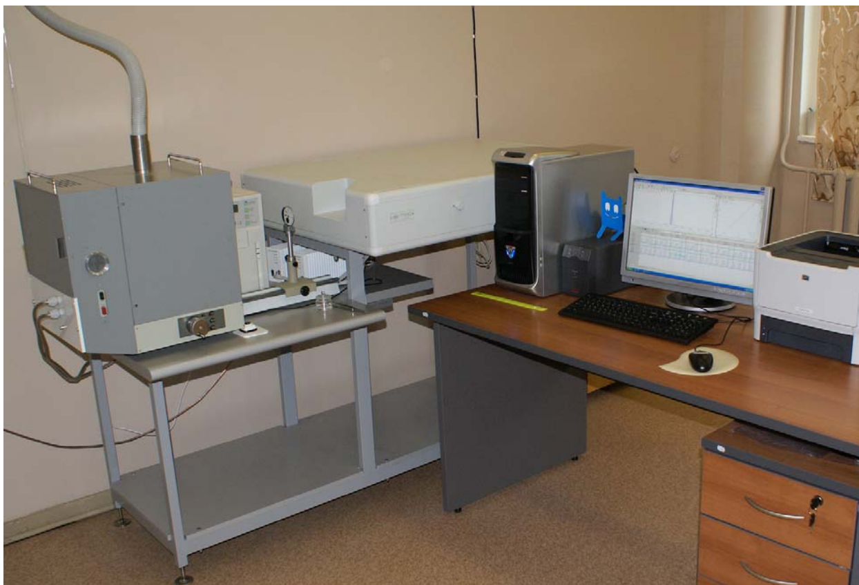
Рис. 11 Спектрометр «Гранд» с генератором «Везувий-2» и универсальным штативом УШТ-4
