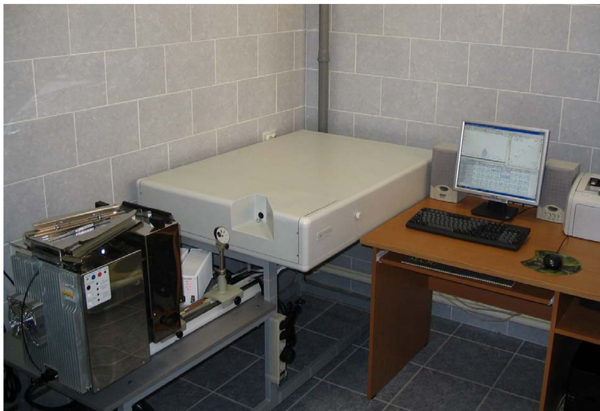
Рис. 10 Спектрометр «Гранд» с электродуговой установкой для анализа порошковых проб методом просыпки-вдувания «Поток»
