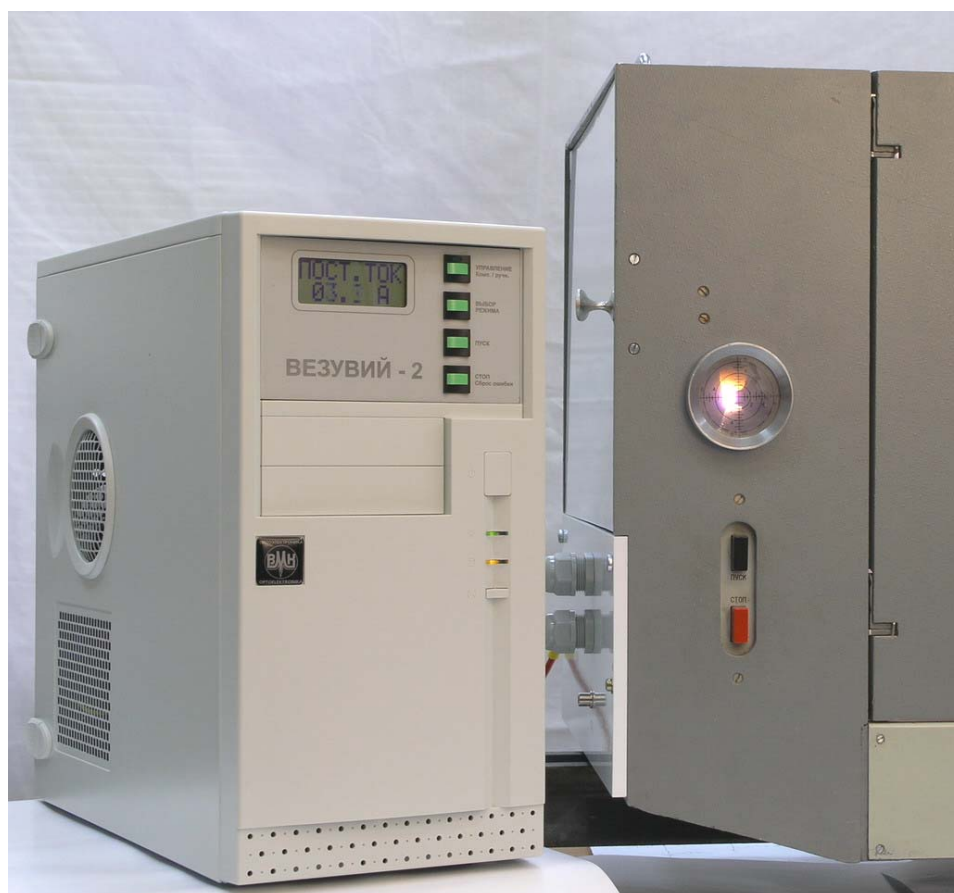
Рис. 4 Внешний вид генератора «Везувий-2», подключенного к универсальному штативу УШТ-4
