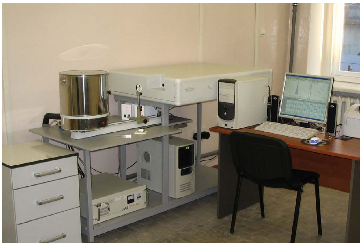
Рис. 12 Спектрометр «Гранд» с генератором «Шаровая молния» и универсальным штативом «Глобула»
