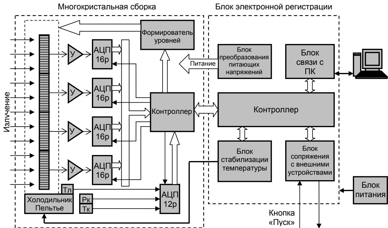
Рис.1. Функциональная схема анализатора МАЭС с  $T_{min} = 1$  мс
