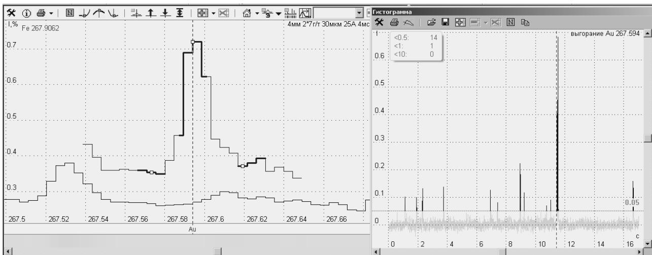
Рис.2а. участок спектра с линией золота с разметкой точек интегрирования и фона. Линия внизу – средний спектр за все время регистрации
