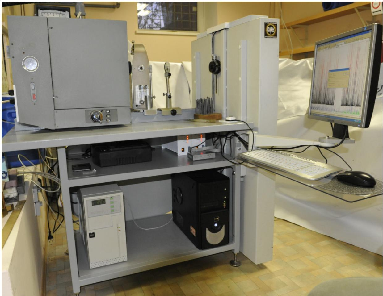
Такая компоновка прибора позволяет уменьшить площадь, необходимую для размещения прибора в лаборатории. Установка стола на колеса придает спектрометру мобильность, что может стать актуальным при работе в заводских цехах или при работе на больших экспериментальных физических установках. Первые месяцы работы с двумя собранными приборами показали, что стабильность спектрометра не хуже, чем МФС-8, у которого рама выполнена из чугунного литья.
