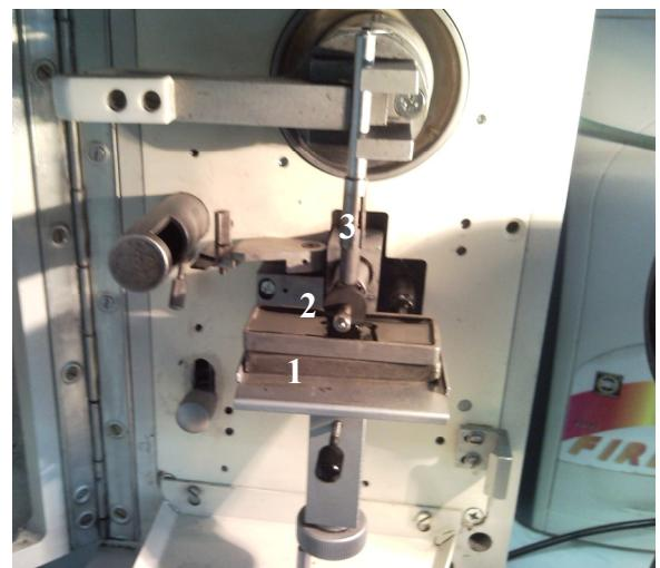
внутренний вид штатива с пробой в ванночке (1) и врачающимся дисковым (2) и подставным стержневым (3) электродами
