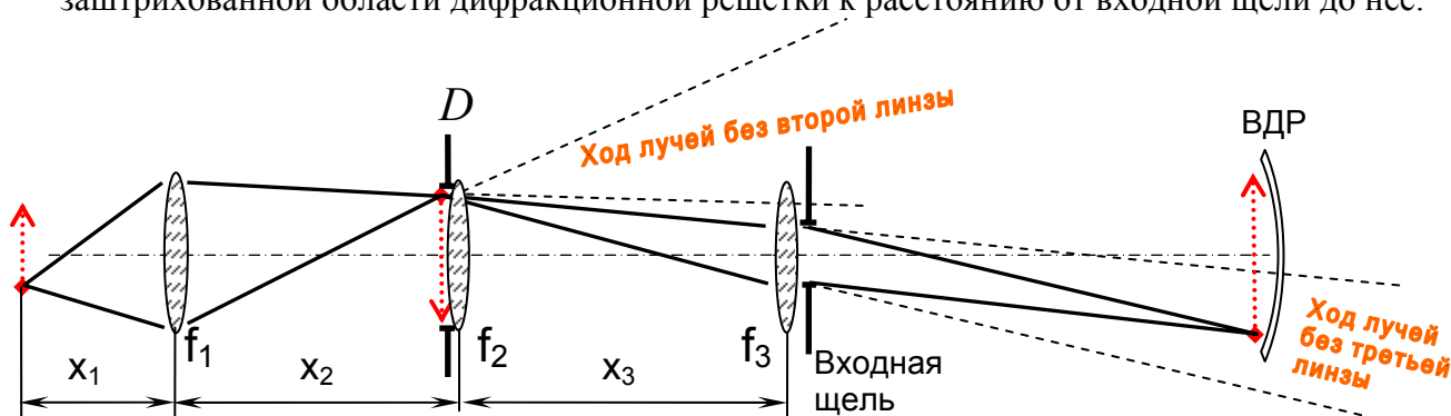
Рис.1. Трёхлинзовая осветительная система с промежуточным изображением
