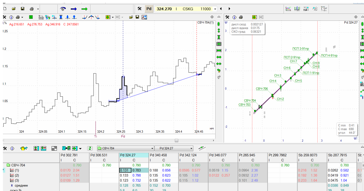
Рис.1. Фрагмент программы Атом с гр. графиком Pd 324,270 и участком спектра с соответствующей линией при концентрации палладия 0,79 ppm
