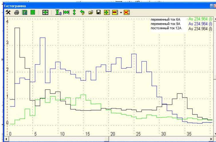
Рис.4. Кривые испарения линии As 234,984 нм при различных режимах возбуждения: переменный ток силой 6 А, переменный ток силой 9 А, постоянный ток силой 12 А
