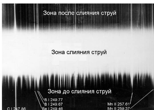
Рис. 1. Фотография спектра плазменного потока, полученного при введении 20 мг графитового порошка
