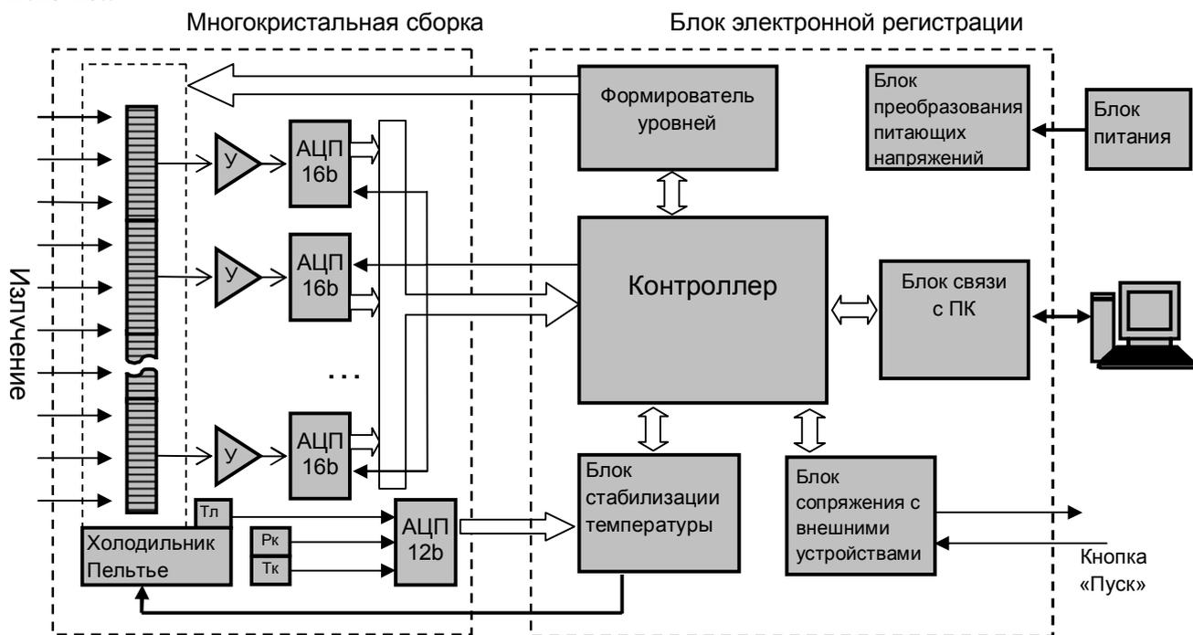
Рис.1. Схема быстродействующего анализатора МАЭС с параллельной схемой чтения
