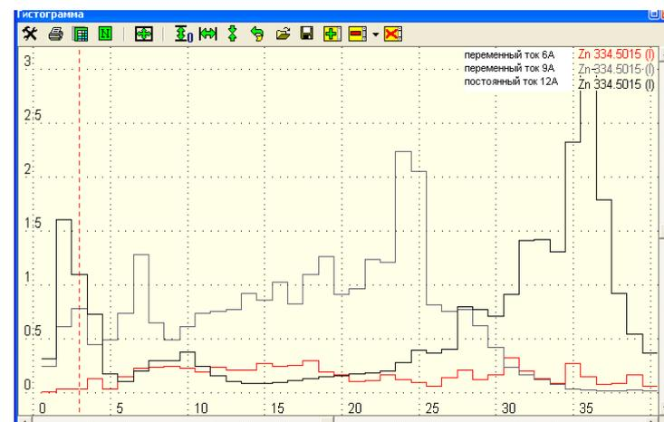
Рис.12. Кривые испарения линии Zn 334,5015 нм при различных режимах возбуждения: переменный ток силой 6 А, переменный ток силой 9 А, постоянный ток силой 12 А
