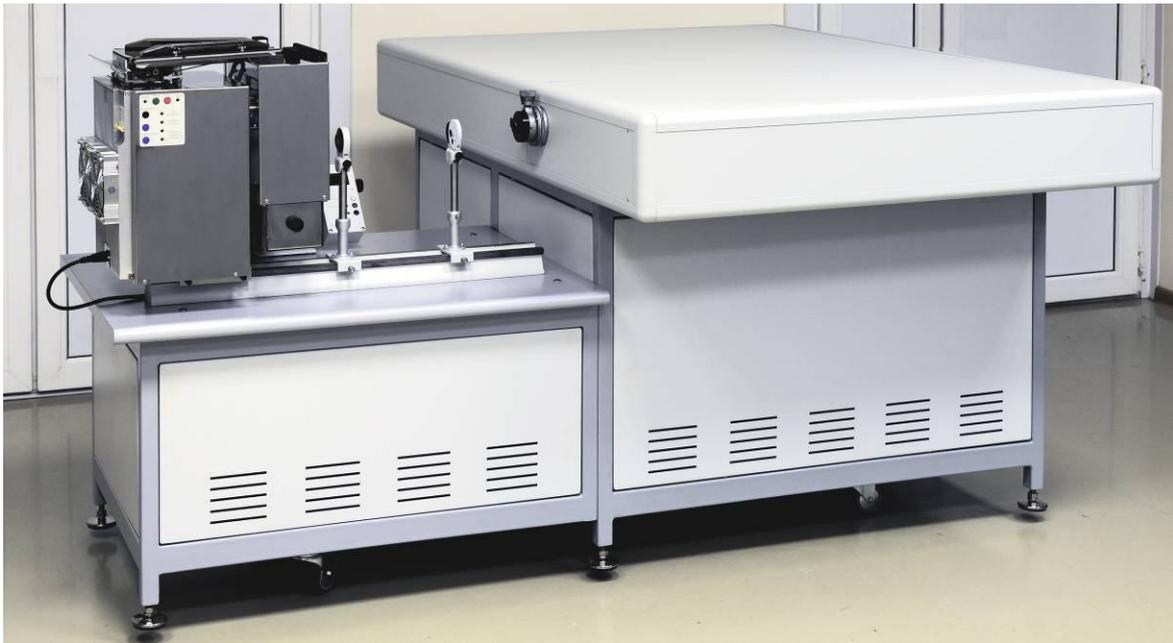
Рис.3. Внешний вид спектрометра высокого разрешения «Гранд-1500» с электродуговой установкой для анализа порошковых проб методом просыпки-вдувания «Поток»
