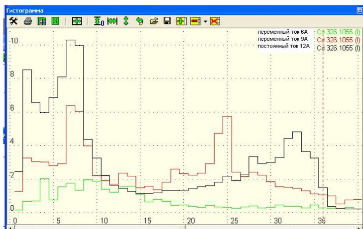
Рис.6. Кривые испарения линии Cd 326,1055 нм при различных режимах возбуждения: переменный ток силой 6 А, переменный ток силой 9 А, постоянный ток силой 12 А
