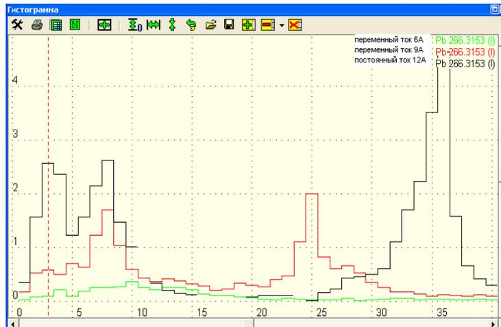
Рис.7. Кривые испарения линии Pb 266,3153 нм при различных режимах возбуждения: переменный ток силой 6 А, переменный ток силой 9 А, постоянный ток силой 12 А
