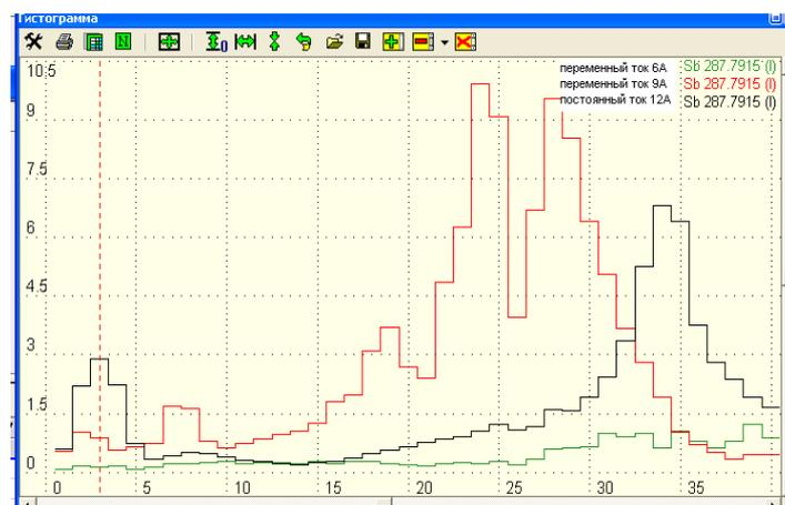
Рис.9. Кривые испарения линии Sb 287,7915 нм при различных режимах возбуждения: переменный ток силой 6 А, переменный ток силой 9 А, постоянный ток силой 12 А
