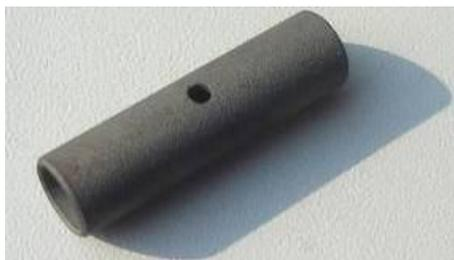
В качестве источника паров атомов используется электротермический атомизатор (ЭТА) собственной конструкции. В него устанавливаются трубочки продольного нагрева, которые используются во многих серийных приборах (рис. 3).
