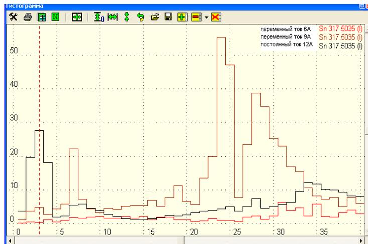
Рис.10. Кривые испарения линии Sn 317,5035 нм при различных режимах возбуждения: переменный ток силой 6 А, переменный ток силой 9 А, постоянный ток силой 12 А
