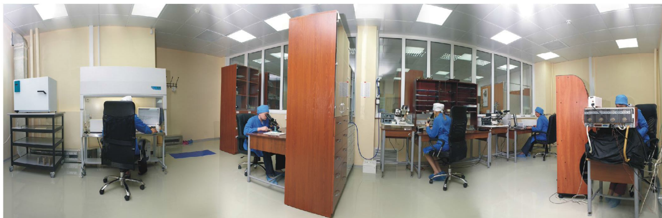
Производственный участок по созданию многокристалльных сборок анализаторов МАЭС – «Чистая комната»
