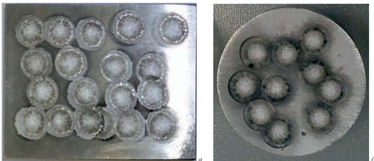
Рис. 3. Пятна обыскривания на поверхности проб стали (а) и первичного алюминия (б)
