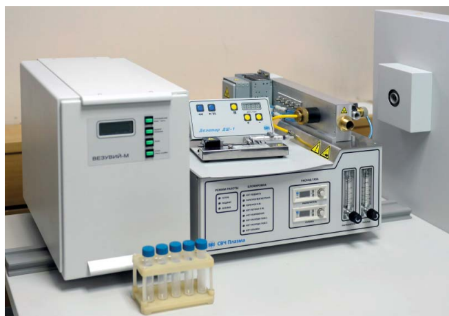
Рис. 3. Фотография спектрометра с микроволновой плазмой с внешним источником питания «Везувий-М»
