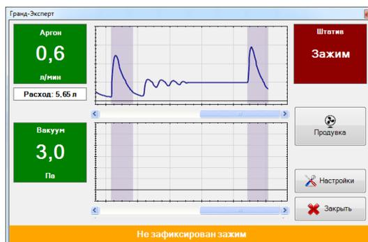
Рис. 4. Модуль управления «Аргоновый штатив»
