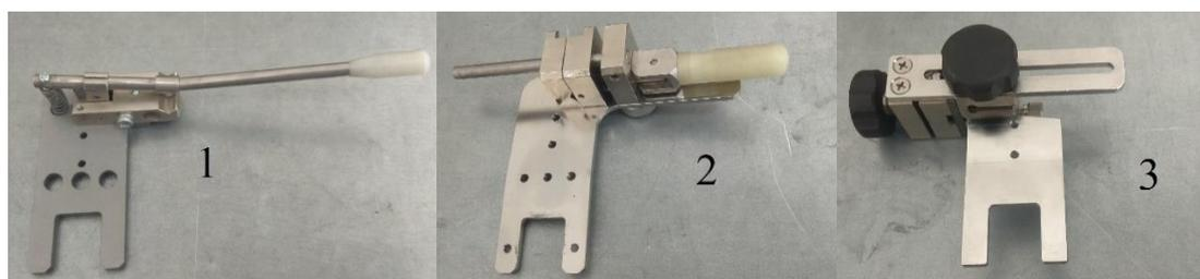
Рис. 1. Виды держателей, опробованные в лаборатории
