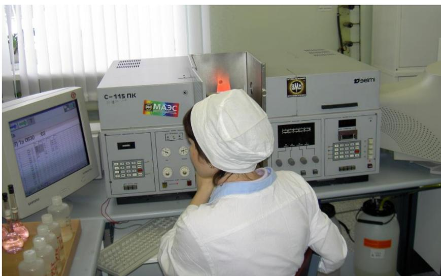
Рис. 2. Атомно-эмиссионный спектрометр С-115 с анализатором МАЭС
