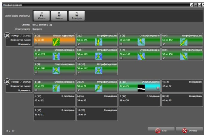
Рис. 18. Процесс автоматической калибровки по длинам волн.
