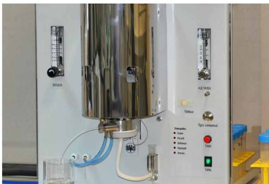
Рис. 3. Атомно-эмиссионный спектрометр «Павлин»
