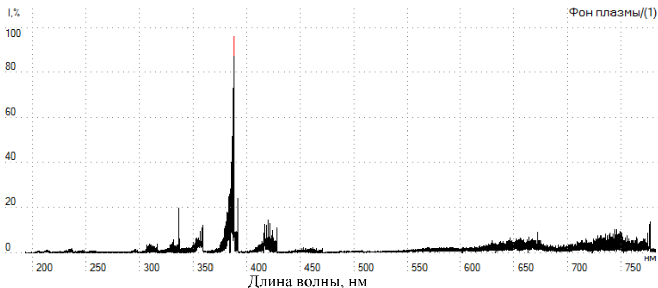
Рис. 4. Обзорный спектр азотной микроволновой плазмы, зарегистрированный анализаторами МАЭС
