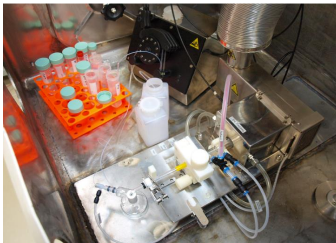
Рис. 3. Внутреннее содержимое химического бокса, резонатор и система ввода пробы
