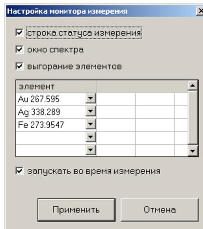
Инструмент предназначен для наблюдения в реальном времени за ходом экспозиции, текущим спектром и поступлением заранее выбранных элементов в окне программы.
