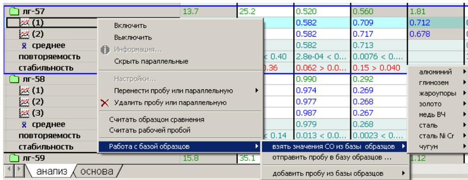
С помощью этого меню можно «включить/выключить» всю пробу/параллельную или только Сос. Образец сравнения с отключенной Сос (пункты меню «Считать рабочей пробой») рассматривается программой как рабочая проба, для нее вычисляется концентрация и выполняется соответствующий статконтроль.
