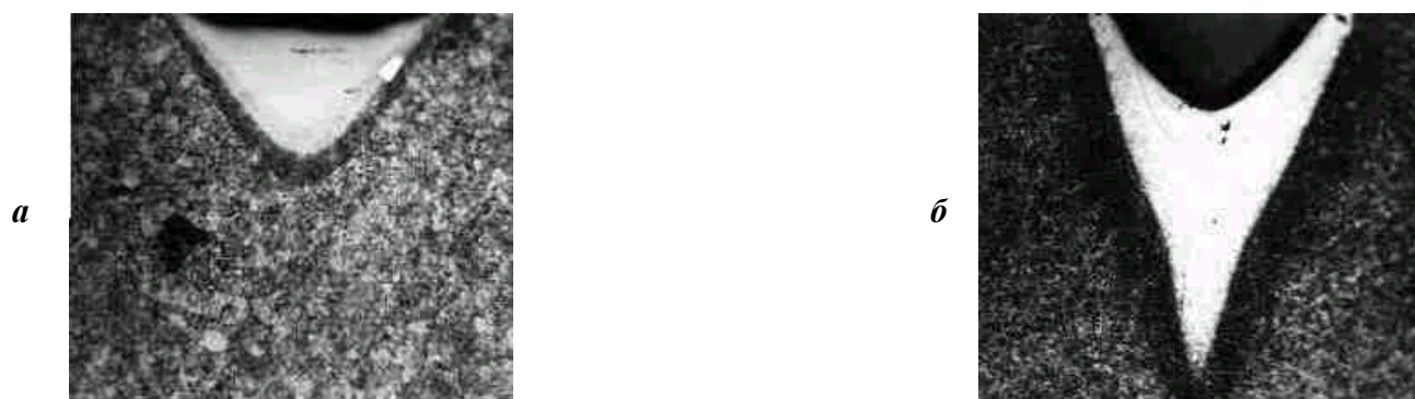
Рис. 4. Продольные разрезы кратеров на образцах отожженной ( а ) и закаленной ( б ) стали ШХ15. \times 150
