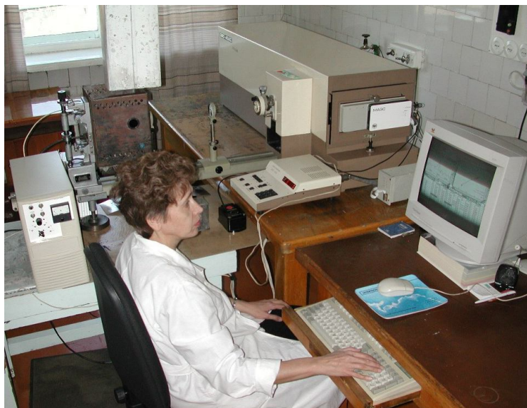
Рис. 2. Спектральный комплекс для атомно-эмиссионного определения макро- и микроэлементов (спектрограф ДФС-458, МАЭС, Везувий).
