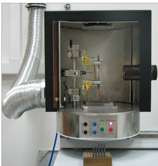
Рис. 1. Спектроаналитический штатив «Глобула»
