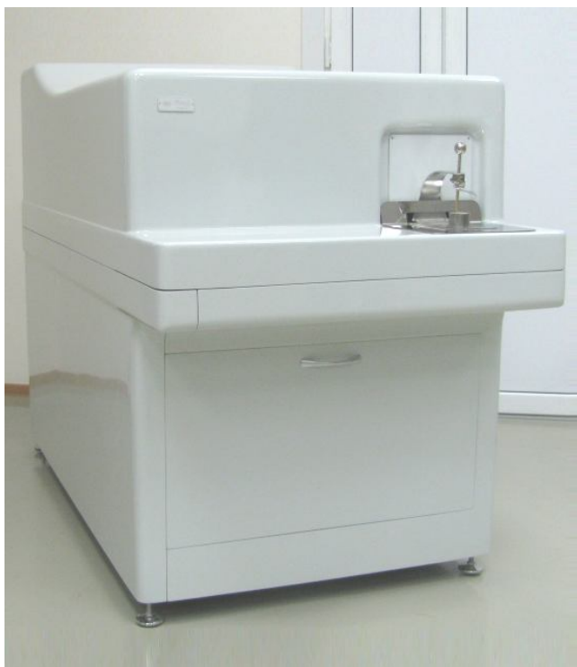
Рис.1. Внешний вид спектрометра «Гранд-Эксперт»
