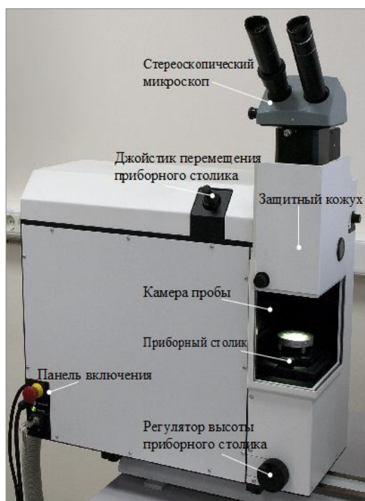
Рис. 3. Двухимпульсный лазерный источник возбуждения атомно-эмиссионных спектров
