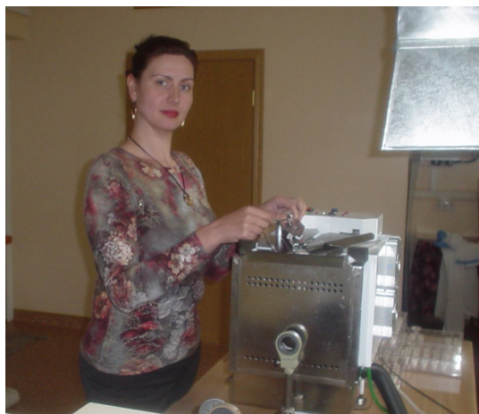
Рис. 4. Спектральный комплекс для дугового атомно-эмиссионного анализа порошковых проб по способу вдувания-просыпки (спектрограф ДФС-458, МАЭС, ПОТОК).
