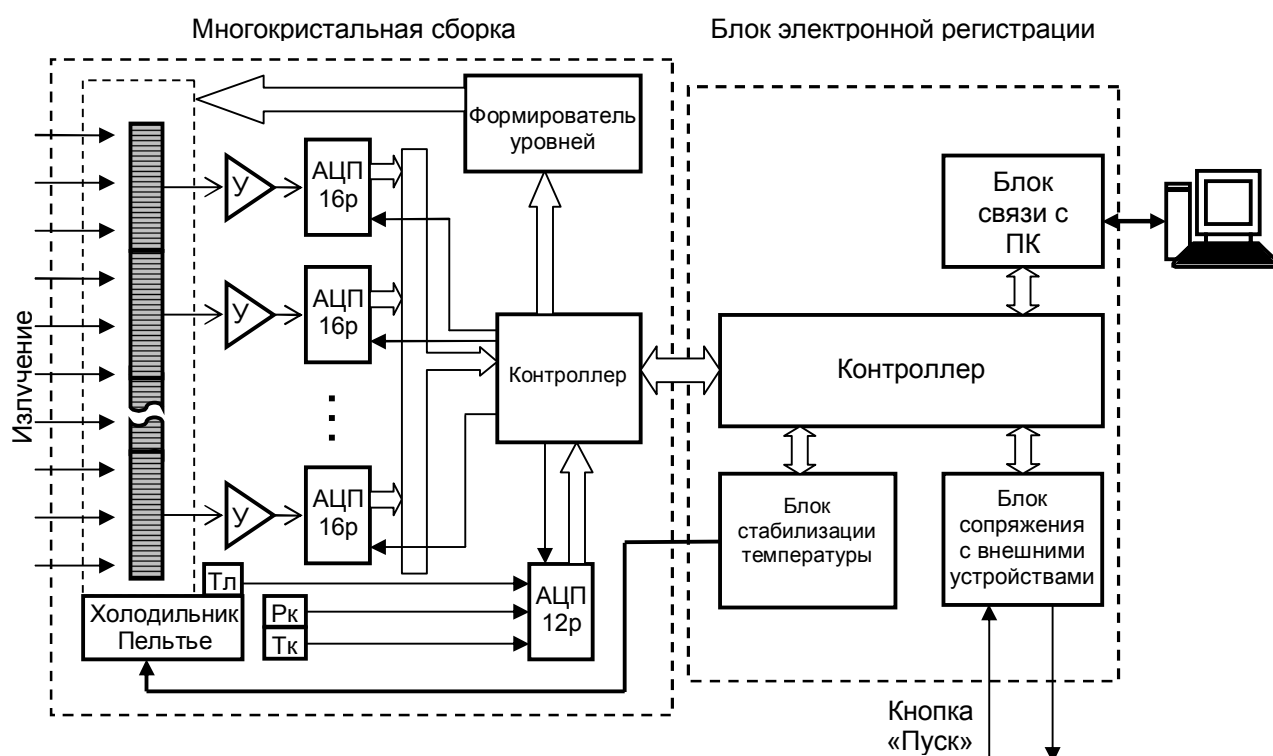
Рис. 1. Структурная схема анализатора с параллельной схемой чтения
