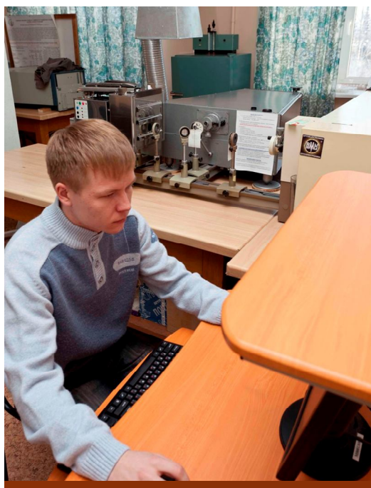
Рис. 6. Спектральный комплекс для сцинтилляционного атомно-эмиссионного анализа с высоким временным разрешением (спектрограф СТЭ-1, высокоскоростная МАЭС, «Поток») и дугового АЭА порошковых образцов по способу вдувания-просыпки (спектрограф ДФС-458, МАЭС, «Поток»)
