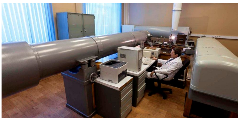
Рис. 1. Спектральный комплекс для дугового атомно-эмиссионного анализа порошковых образцов по способу испарения из канала электрода (спектрографы ДФС-8, ДФС-13, PGS-2; МАЭС, Шаровая молния).
