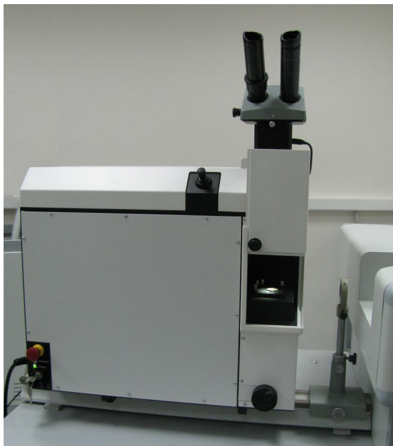
Рис.2. Внешний вид лазерного источника возбуждения спектров
