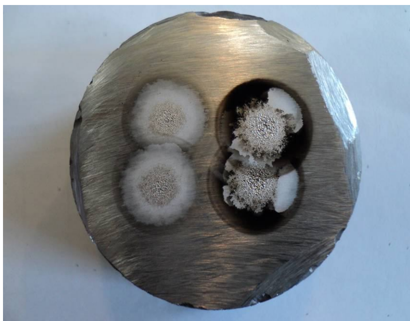
Рис.1 Вид пятен прожига: слева – полученные с помощью генератора ИВС-500-4, справа – с генератором «Шаровая молния» ШМ-250
