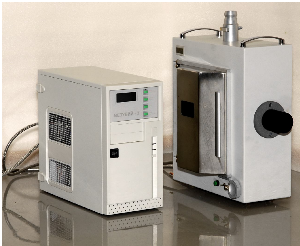
Рис.1. Штатив «Кристалл» с генератором «Везувий-3»
